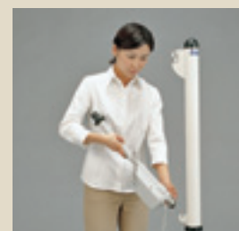
▲モーターを支柱から取り外します。
